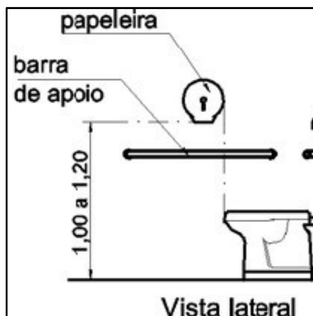
Figura 5: Indicação da NBR 9.050 sobre instalação de papeleiras.
