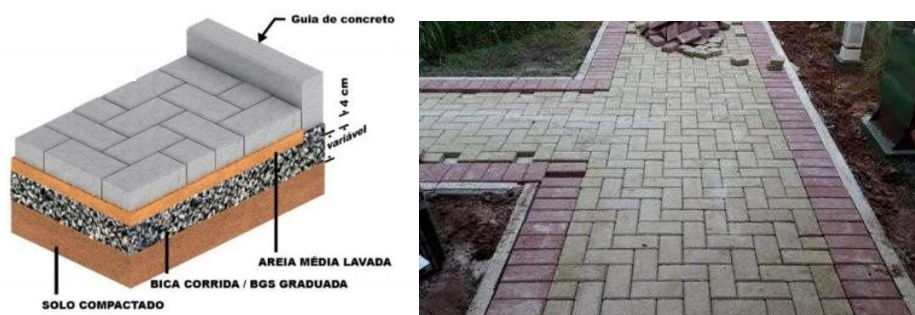
Figura 2: Exemplo assentamento paver.
